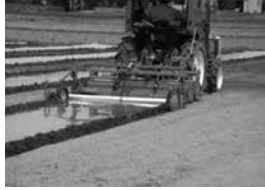
散布混和・畝立同時マルチ (トラクター装着)
